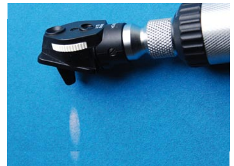
Abb.8: Risslupe mit Lichtquelle
