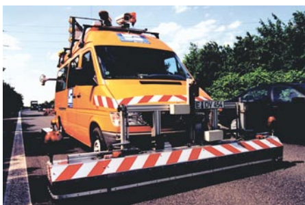
Abb.5: Sonderfahrzeug zur Bestandsaufnahme der Oberflächen von Verkehrswegen (Quelle: Schniering Ing.-Gesellschaft, Essen).
